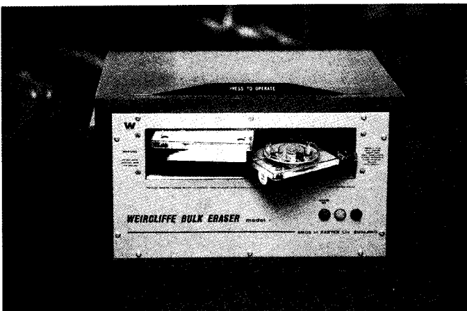
③ Zum Löschen der Cartridges ist ein spezielles Gerät, das vier Kassetten in einem Durchgang löscht, notwendig
